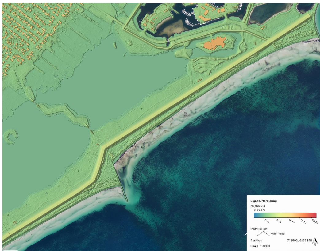
Figur 9-17: 3D præsentation af indre og ydre dige med sikringsniveau 400 cm DVR90 langs Hundige Strand og Ishøj Strand i Ishøj Kommune
