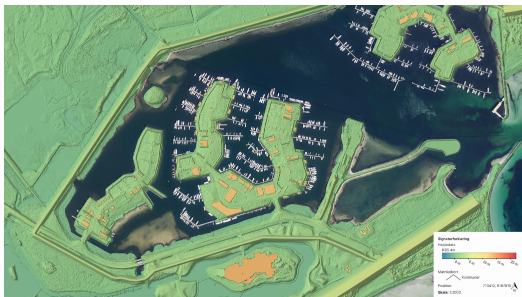
Figur 9-17: 3D præsentation af indre og ydre dige med sikringsniveau 400 cm DVR90 langs Hundige Strand og Ishøj Strand i Ishøj Kommune
