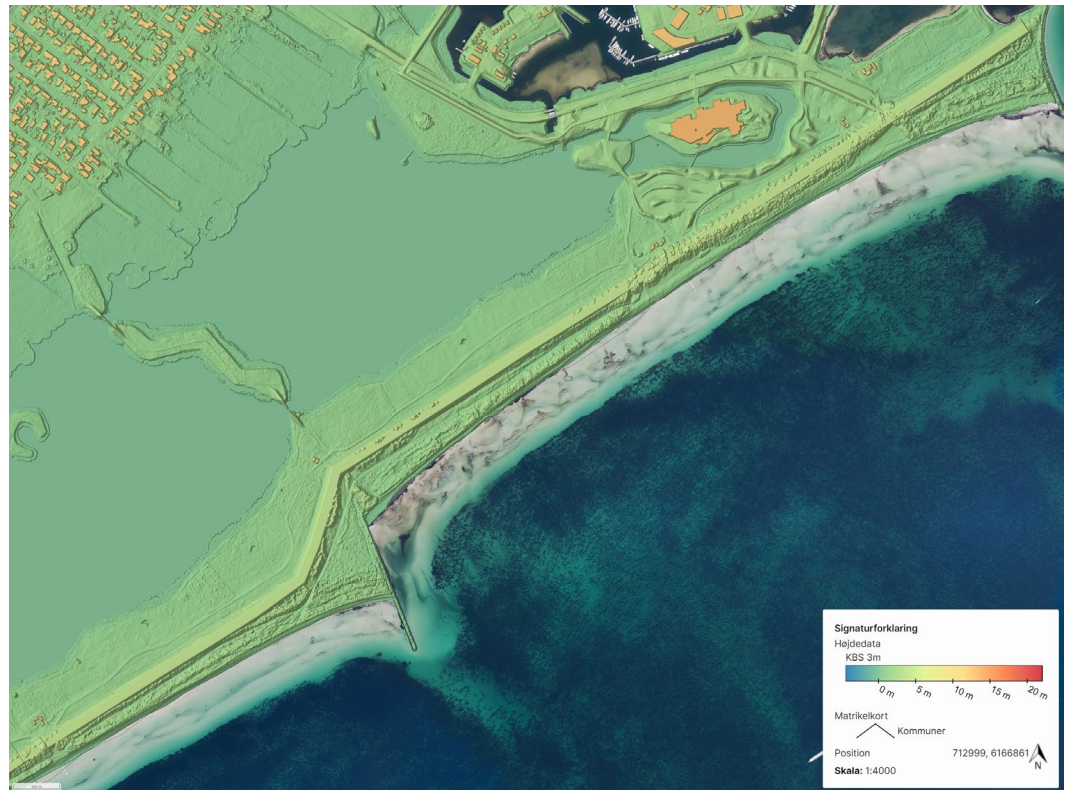
Figur 9-3: 3D præsentation af indre og ydre dige med sikringsniveau 300 cm DVR90 langs Hundige Strand og Ishøj Strand i Ishøj Kommune
