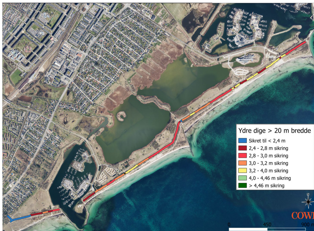
Figur 3-12: Højde af kystbeskyttelsen på det ydre dige med en bredde på mindst 20 m, vestlige del af Køge Bugt Strandpark
