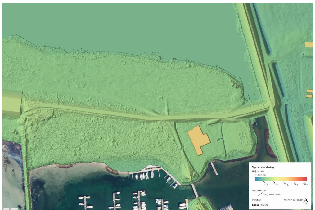
Figur 9-13: 3D præsentation af dige med sikringsniveau 320 cm DVR90 langs Brøndby Strand i Brøndby Kommune
