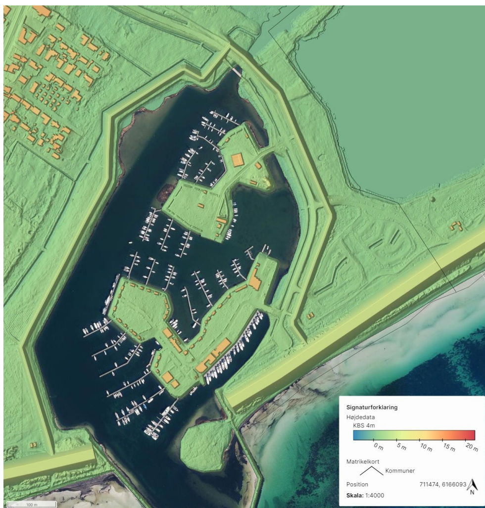
Figur 9-15: 3D præsentation af indre og ydre dige med sikringsniveau 400 cm DVR90 langs Olsbæk Strand i Greve Kommune
